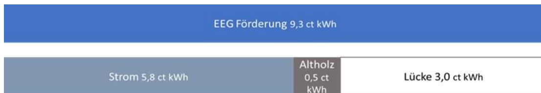
Abb. 2: Bestehende „Lücke“ zwischen EEG-Förderung und Kraftwerkserlösen
